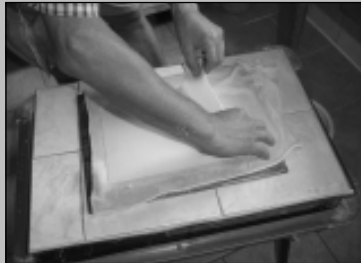
Zdejmowane z sita kartki przekładane są tkaninami.
