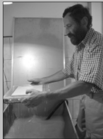
W wannie czerpalnej przy pomocy sita wyławiane są włókna celulozy.
