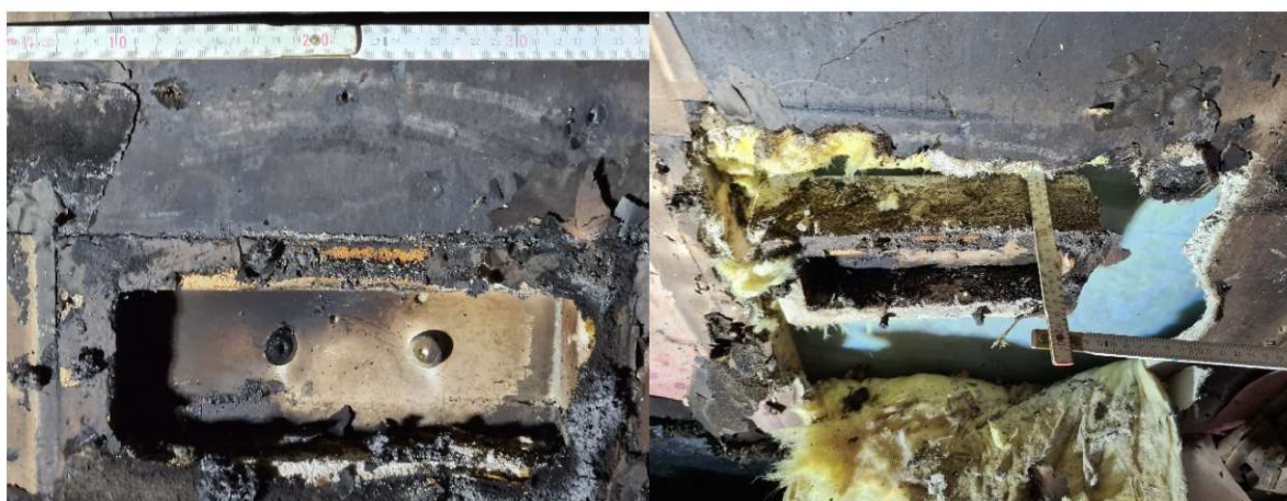
Fot. 6.21. Prawidłowo wykonana puszka instalacji elektrycznej charakteryzująca się odpowiednią klasą odporności ogniowej: a) widok puszki po badaniu ogniowym, b) widok puszki po demontażu okładzin do których została zamontowana. (fot. P. Sulik)
