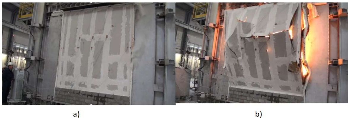
Fot. 6.13. Widok ściany nośnej o drewnianym szkielecie z okładzinami gipsowo-kartonowymi: a) w trakcie badania, b) po przekroczeniu 60 minut, w trakcie zniszczenia (fot. Z archiwum ITB)
