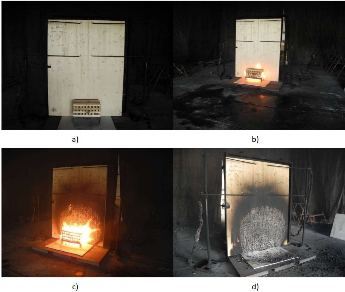
Fot. 6.9. Widok drewnianych, klejonych elementów przed, w trakcie i po badaniu wg [N2]: a) próbka przed rozpoczęciem i b) – elementy drewniane zabezpieczone impregnatem uniepalniającym, nie rozprzestrzeniły ognia (fot. P. Sulik)
