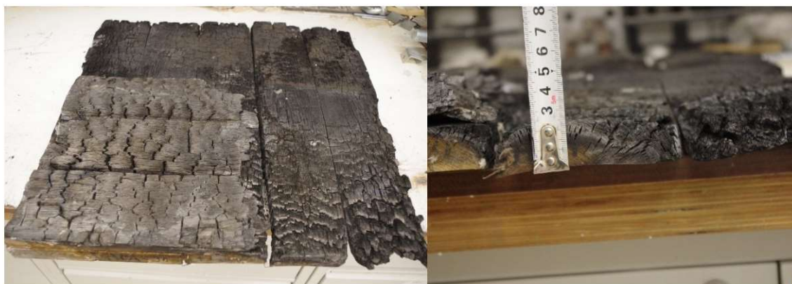
Fot. 6.15. Widok zwęgliny drewna sosnowego po ustaniu bezpośredniego działania ognia (fot. P. Sulik)
